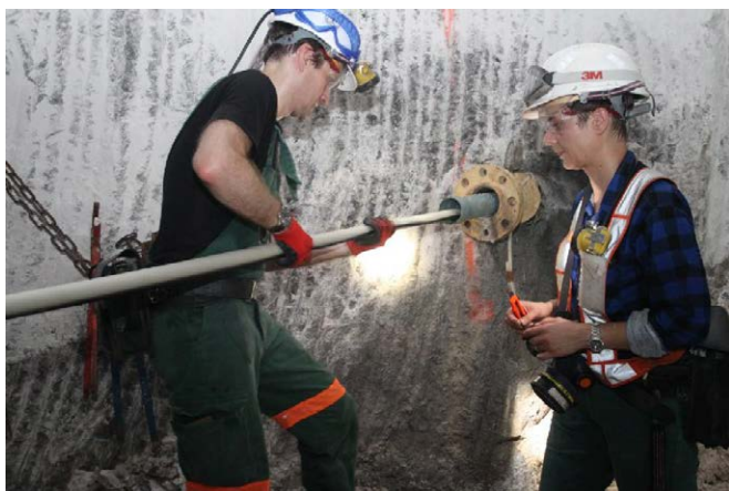
Ryc. 7. Pomiar georadarem otworowym w otworze wiertniczym.
