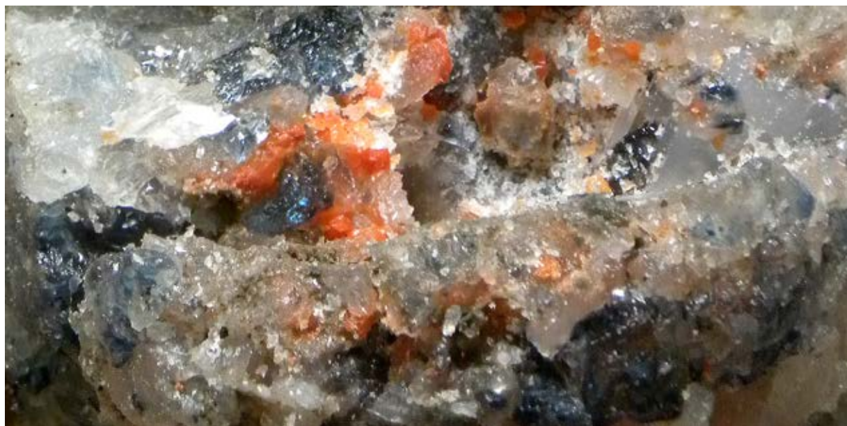
Ryc. 4. Chaotyczna makrotekstura plamistego silwinitu (rzeczywisty rozmiar w świetle przechodzącym) Fig. 4. Disordely macrotexture of mottled sylvinite (real size in transmitted light)
