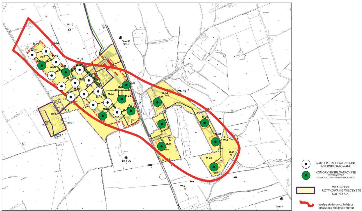
Ryc. 4. Mapa sytuacyjno-wysokościowa Kopalni Soli Mogilno – otwory eksploatacyjne wyłączane oraz pozostające w czynnej eksploatacji
