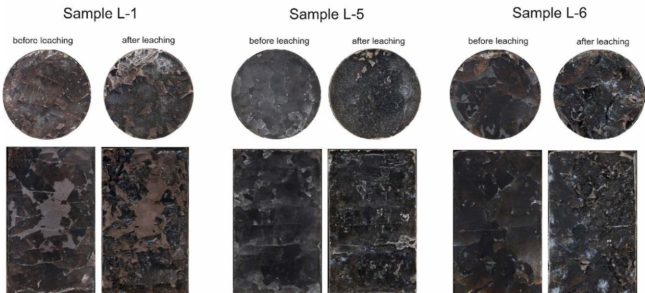
Ryc. 6. Skany prób przed i po ługowaniu stropowym oraz bocznym Fig. 6. Scans of samples before and after vertical and horizontal leaching.
