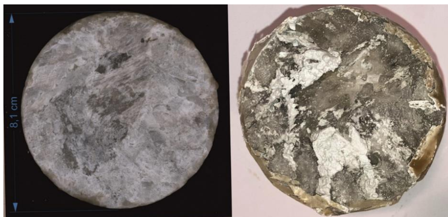
Ryc. 4. Porównanie ługowanej płaszczyzny próby tenardytu – przed ługowaniem (po lewej), po ługowaniu (po prawej) (CHEMKOP, 2022)
