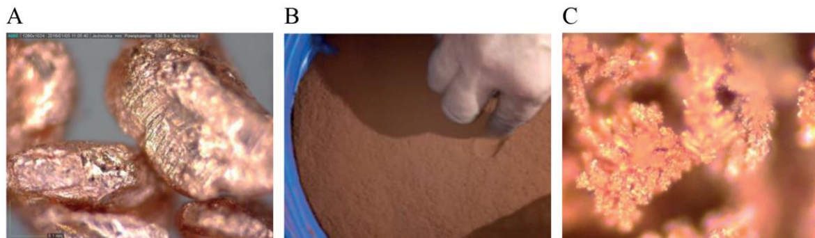
Ryc. 5. Materiały miedziane przetwarzane w instalacji; A – granulaty wsadowy do anody w powiększeniu 530×, B – surowy wysuszony dendrytyczny proszek miedzi, C – próbka proszku pod mikroskopem (ok. 900×) (Źródło: materiały własne laboratorium zakładowego RADO Sp. z o.o.)
