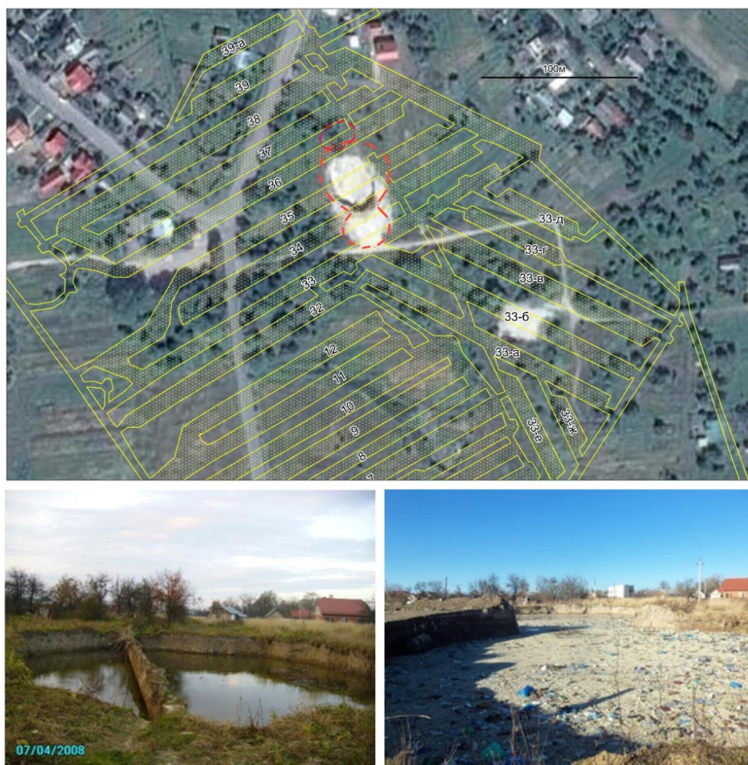
Ryc. 5. System zapadlisk w północnej części północnego pola kainitowego: a) Fragment północnego pola kainitowego (czarne liczby - numery komór, czerwone - numery zapadlisk); b) Zapadlisko nr 14, które powstało wśród zabudowy mieszkalnej miasta Kałusz, kwiecień 2008 roku; c) Połączenie zapadlisk 14 i 14a w jeden system, styczeń 2016 roku.
