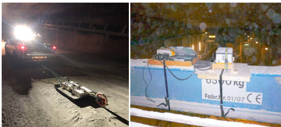
Ryc. 1: Anteny GPR ciągnięte za pojazdem podczas badania na spągu (po lewej) oraz przymocowane do suwnicy podczas badania na stropie (po prawej).
