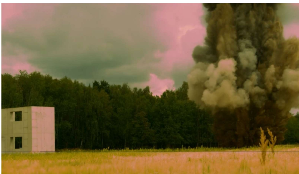
Rys. 3. Detonacja ładunku w odległości 2 m od schronu DN3000 z rury PE Weholite (fot. Pelter) Fig. 3. Detonation of a charge at a distance of 2 m from a DN3000 shelter made of Weholite PE pipe (photo: Pelter)
