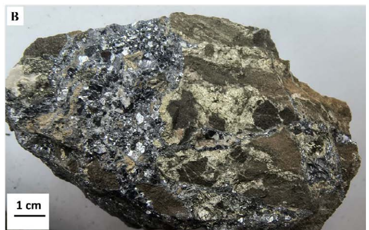
Ryc. 4. Struktura solna Kebbouch. A – Panorama ze szczytu wzgórza zbudowanego ze zwietrzelin triasowych ewaporatów (czapa siarczanowo-dolomitowo-ilasta) w rejonie czynnej kopalni rud cynku i ołowiu Kebbouch. B – parageneza galenowo-sfalerytowa z markasytem i pirytem z kopalni Kebbouch. Lokalizacja na Ryc. 1.
