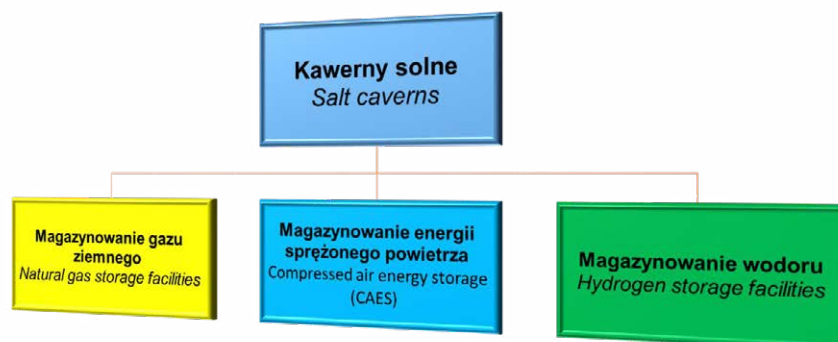
Ryc. 2. Możliwości wykorzystania kawern solnych do magazynowania energii (Na podstawie Polański, 2024).
